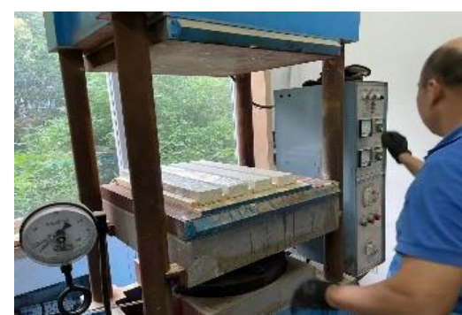
(f) 试件固化
