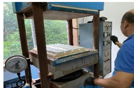
(f) 试件固化
