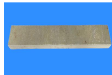
GFRP板增强试件
