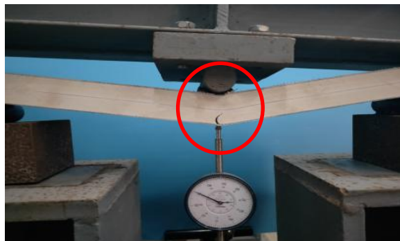
GFRP板增强试件
