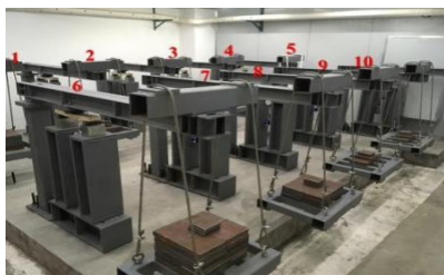
弯曲蠕变加载装置
