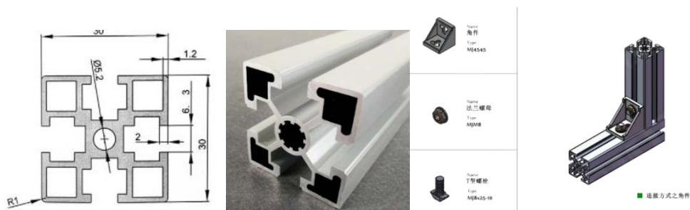
图 A3 45×45 铝合金型材及安装示意图
