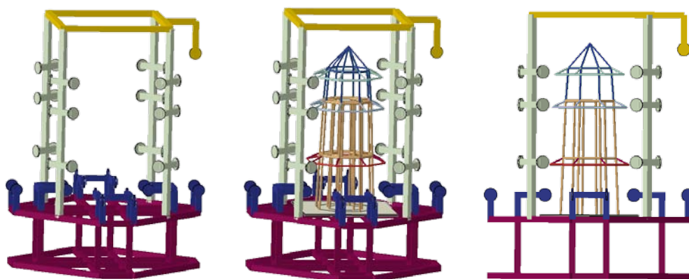
(a) 加载架示意图 (b) 模型安装效果图 (c) 模型安装后侧视图
